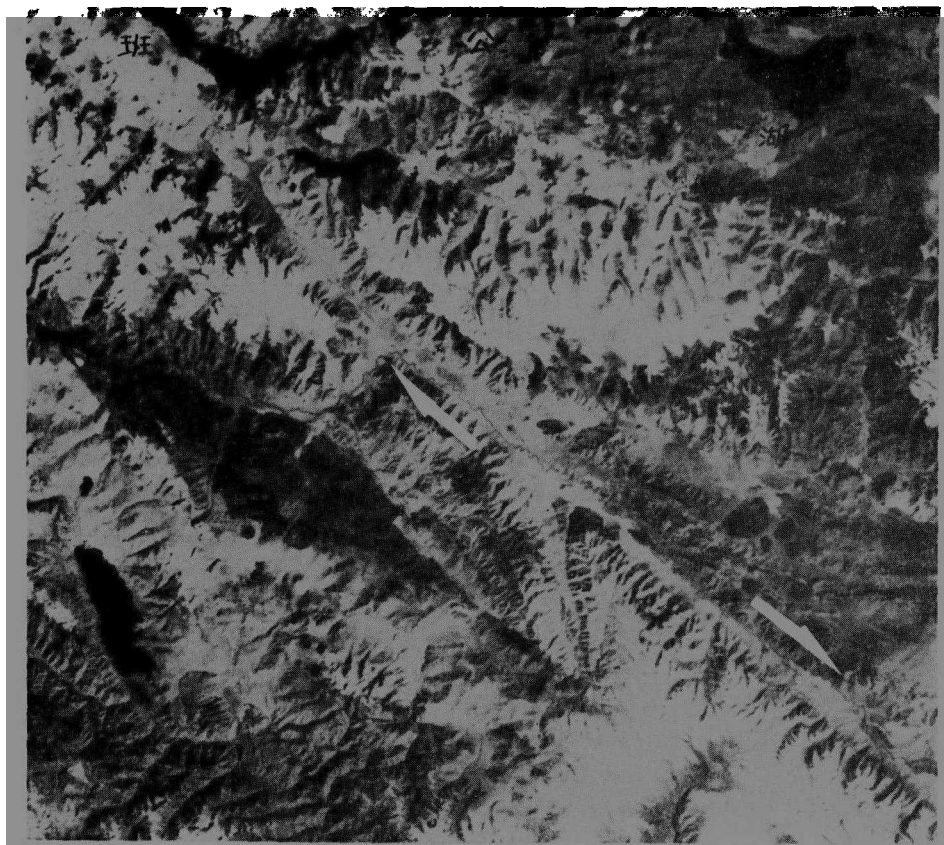
照片 1 地球资源技术卫星(ERIS E-1)拍摄的西藏班公湖附近的喀拉昆仑山右旋走滑平移断层(箭头示断层两盘错动方向)。
